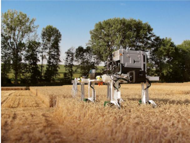
**Der Feldroboter DeBiFix beobachtet ganze Weizenfelder beim Wachstum: Durch das mehrmalige Röntgen des Feldes sind Züchter in der Lage, den Wachstumsverlauf der Körner in den Ähren nachzuvollziehen und so zu entscheiden, welche Sorten für die Züchtung besonders gut geeignet sind. Der Feldroboter wurde in Kooperation mit der Firma PhenoKey gebaut. © Fraunhofer IIS | Bild in Druckqualität: [www.iis.fraunhofer.de/pr](http://www.iis.fraunhofer.de/pr).**
